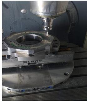
*Figura 27. Realizar el calibrado en superficie especial (preformado).*
