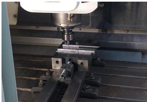
*Figura 21. Iniciar barrenado y rimado.*
