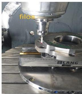
*Figura 25. Realizar el calibrado en superficie (filo superficie abierta).*
