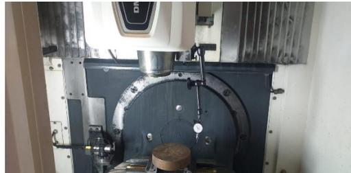
*Figura 20. Escuadrar, alinear y sacar origen (pieza en prensa).*
